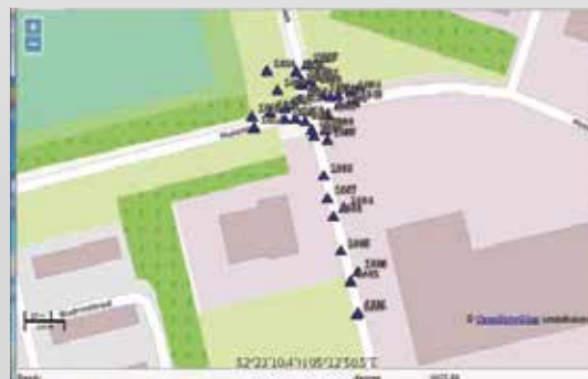
Stop and Go Roverpunkte für Vermessung
